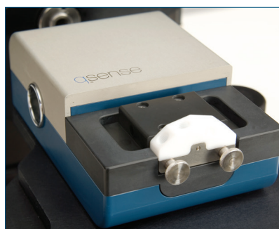
QCM-D Cell on M-2000 Ellipsometer.
