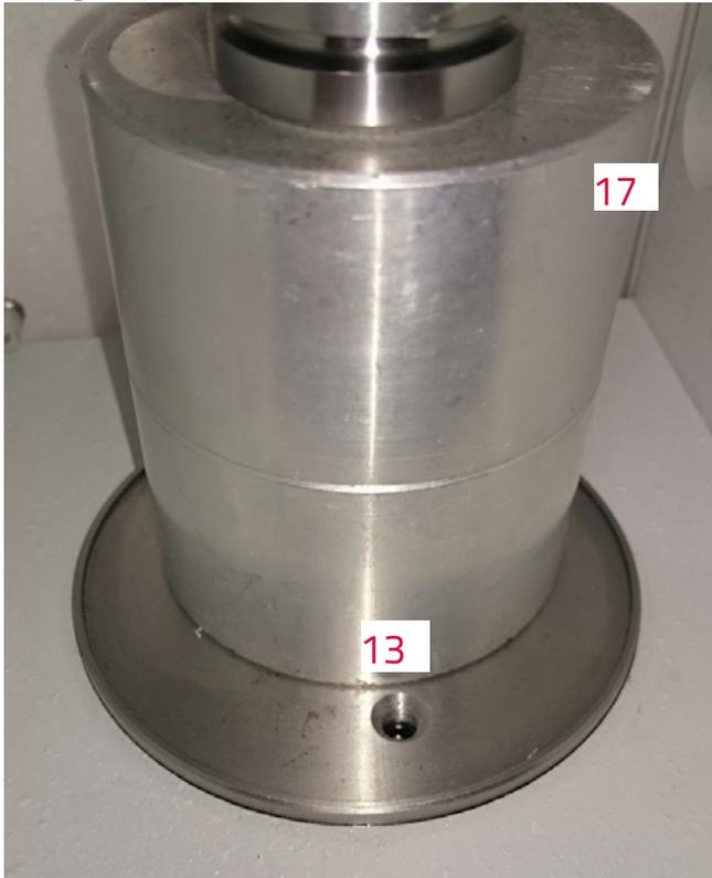
Der Bereich um den **Austrittspunkt des Kolbens (3)** aus dem **Grundkörper (1)** sollte, möglichst **sauber gehalten** werden, da andernfalls **Verschmutzungen zwischen Kolben und dem Zylinder** im Grundkörper gelangen können. Dies kann nach einer gewissen Zeit zum **Versagen des Rückholmechanismus** führen.
